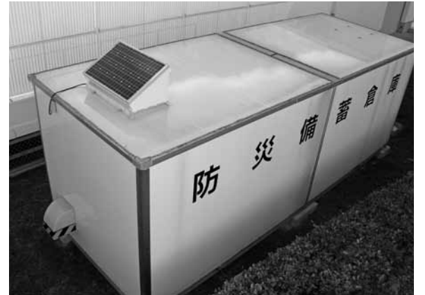
ソーラーパネル付き防災備蓄倉庫
