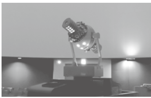
光学式デジタル映像システムを備えたハイブリッド方式のプラネタリウム
