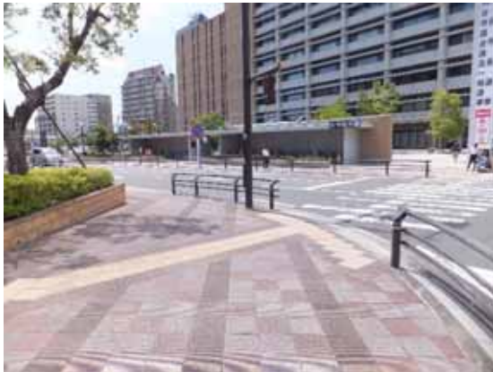
▲視覚障害者誘導用ブロック、エスコートゾーン ▲歩道と横断歩道に段差のないすりつけ部
