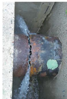
▲水道管の劣化による漏水
